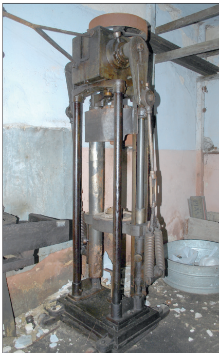
Ryc. 5. Maszyna do wyrobu doniczek. Stan przed translokacją w 2021 roku. Fot. Piotr Czepas
