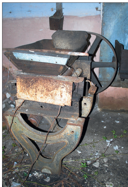
Ryc. 7. Mlewnik walcowy. Stan przed translokacją w 2021 roku. Fot. Piotr Czepas
